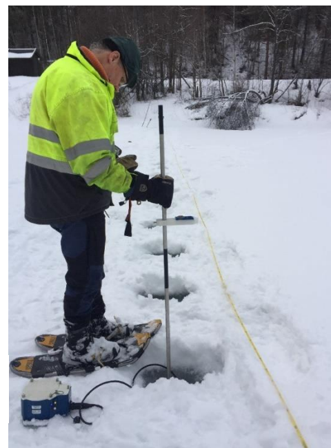
Vintervannføringsmåling med flygel på islagt elv, Tunna. Foto: Hydrateam AS.
